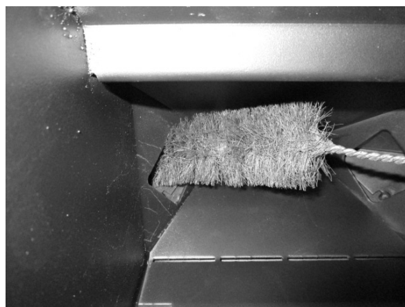
Fig. 47 - Limpieza con escobilla 4
