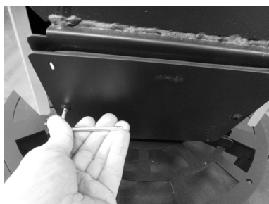
Fig. 37 - Extracción de los tornillos
