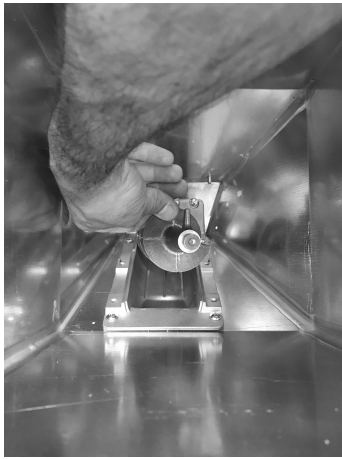
Fig. 33 - Extracción de la espiral
