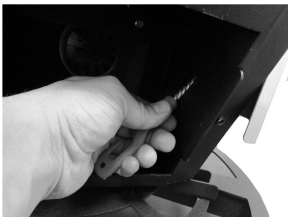
Fig. 46 - Limpieza con escobilla 3
