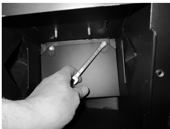
Fig. 40 - Extracción de los tornillos
